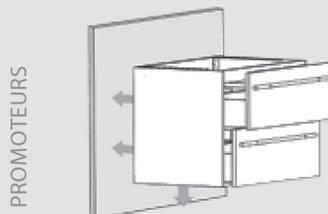
La pose du meuble sur la paroi est identique à celle d'un meuble traditionnel. La mise à niveau ainsi que la fixation sont faites grâce au concept Déclips. Pose avec ou sans piètement.
