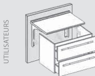
Il suffit de déconnecter le concept Déclips pour désolidariser le meuble du plan. Le meuble pourra retrouver sa position d'origine par l'opération inverse.
