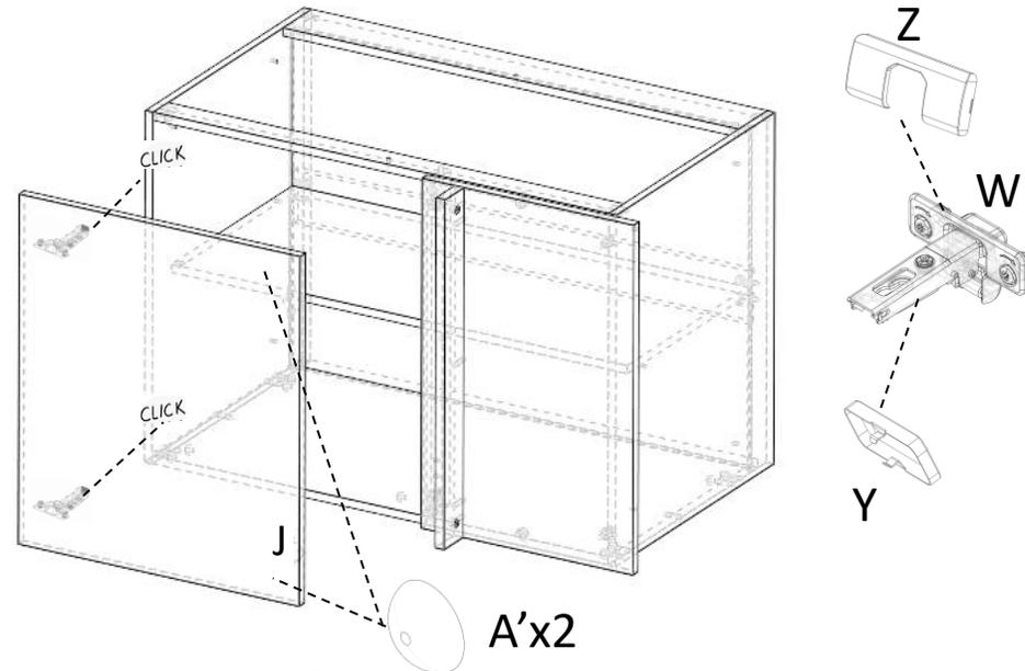
Montage porte J et butées de porte 2x A', caches bras 2x Y et caches boîtier 2x Z
